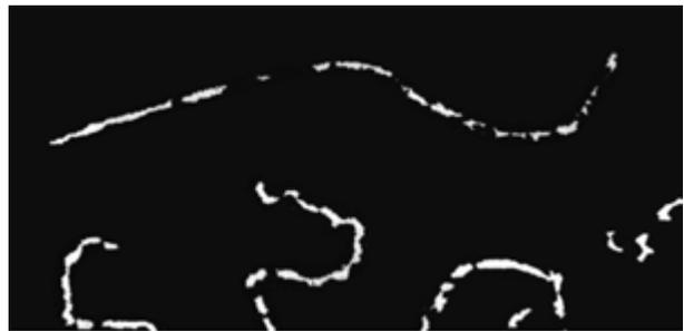
**Abb. 2:** Nebelkammerspuren von Alpha-Teilchen (oben), Protonen (Mitte) und Elektronen (unten).
