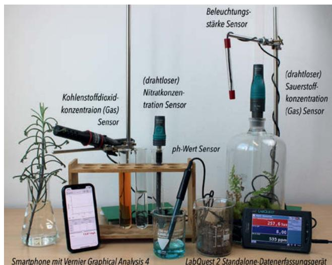
▲ Abb. 1 Externe, digitale Messsensoren von Vernier
