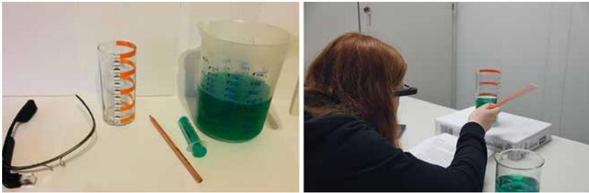
**Abb. 2:** Experimentiermaterialien (links) und Versuchsdurchführung (rechts) zur Bestimmung der Schwingungsfrequenz in Abhängigkeit des Füllstandes eines Wasserglases
