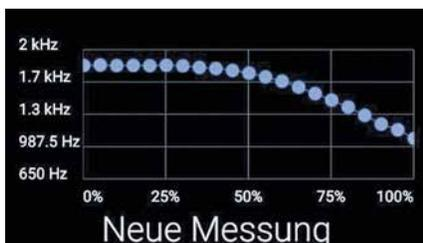
**Abb. 3:** Erfasstes Füllstand-höhe-Frequenz-Diagramm der Google Glass-App
