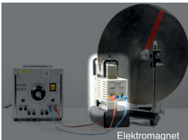
▲ Abb.23 Ausschnitte aus einem Videoclip, in dem ein Experiment zur Wirbelstrombremse erläutert wird
