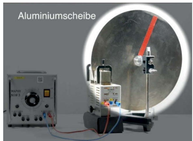
▲ Abb.23 Ausschnitte aus einem Videoclip, in dem ein Experiment zur Wirbelstrombremse erläutert wird
