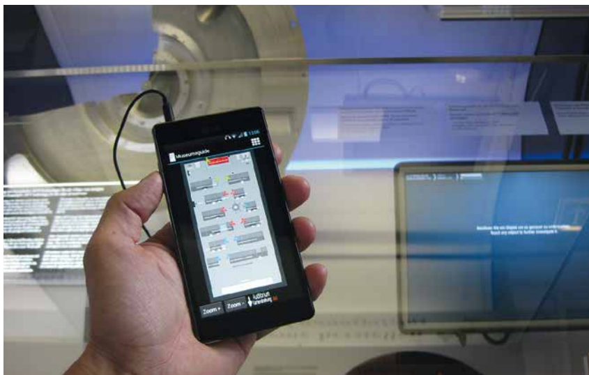
Abb. 3: Prototyp eines Multimedia-Guides für das Zentrum Neue Technologien im Deutschen Museum in München: Besucherinnen und Besucher werden mit einem Smartphone durch die Ausstellung geleitet, ein System zur Positionsorientierung unterstützt das Auffinden der zentralen Exponate. (Foto: Lorenz Kampschulte)
