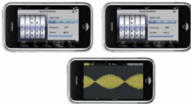
Abb. 1: Untersuchung einer akustischen Schwebung: Zwei Smartphones erzeugen zwei Töne mit geringem Frequenzunterschied (hier mit Hilfe der iOS-App »Audio Kit«), die durch die Überlagerung der beiden Schallschwingungen erzeugte akustische Schwebung wird hier mit der iOS-App »Oszilloskop« erfasst.
